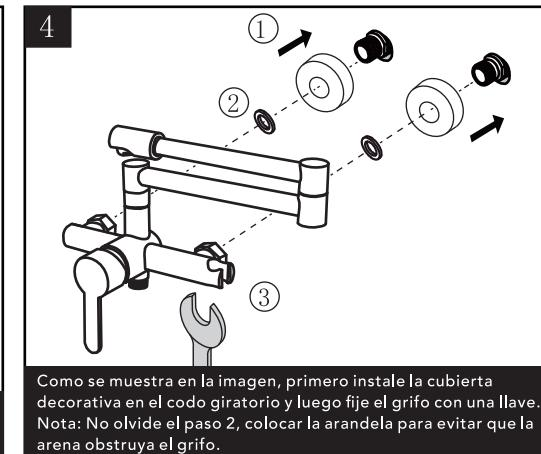
Como se muestra en la imagen, primero instale la cubierta decorativa en el codo giratorio y luego fije el grifo con una llave. Nota: No olvide el paso 2, colocar la arandela para evitar que la arena obstruya el grifo.
