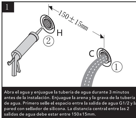
Abra el agua y enjuague la tubería de agua durante 3 minutos antes de la instalación. Enjuague la arena y la grava de la tubería de agua. Primero sellé el espacio entre la salida de agua G1/2 y la pared con sellador de silicona. La distancia central entre las 2 salidas de agua debe estar entre  $150\pm15\text{mm}$ .
