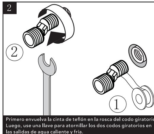
Primero envuelva la cinta de teflón en la rosca del codo giratorio. Luego, use una llave para atornillar los dos codos giratorios en las salidas de agua caliente y fría.
