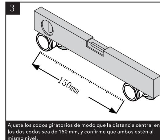
Ajuste los codos giratorios de modo que la distancia central entre los dos codos sea de 150 mm, y confirme que ambos estén al mismo nivel.
