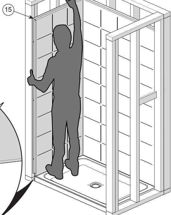
Perforar los pre-agujeros de la brida del muro lateral solamente (15), con una broca de 1/8" alineando con cada montante. **No perforar los montantes.** Fijar el muro temporalmente a un montante usando un tornillo # 8 x 1 1/4" (no incluido).
