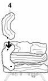
Fig. 22 - Instalación de leño #4
