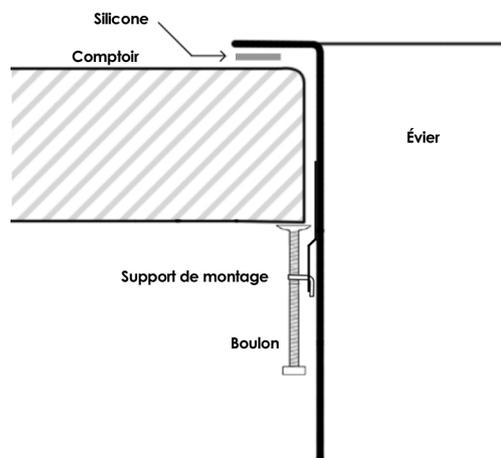
Insérez les supports de montage sur le côté des parois extérieures des éviers dans les fentes prévues à cet effet.
