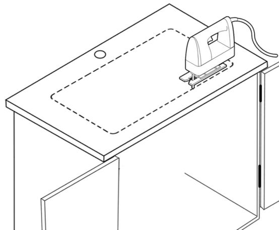
Tracez le contour du gabarit et découpez le comptoir selon le contour du gabarit en utilisant les outils de coupe appropriés. Le modèle est donné à titre indicatif seulement. Utilisez un évier pour assurer une ouverture précise de la découpe. Il est recommandé d'utiliser les dimensions réelles de l'évier pour assurer la découpe la plus précise possible. Le dessin ou le gabarit sert de référence.
