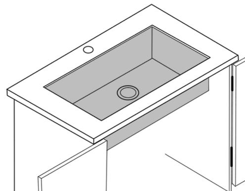
Vérifiez à nouveau l'alignement de l'évier et resserrez les attaches pour sécuriser l'évier. Essuyez l'excès de mastic silicone avec un chiffon humide. Raccordez l'évacuation et l'alimentation en eau conformément aux instructions du fabricant.
