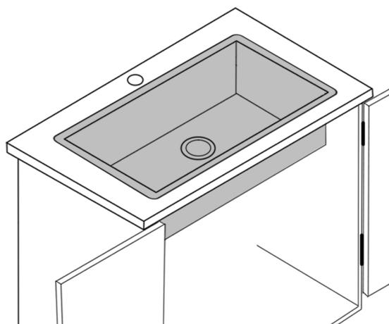
Vérifiez à nouveau l'alignement de l'évier et resserrez les attaches pour sécuriser l'évier. Essuyez l'excès de mastic silicone avec un chiffon humide. Raccordez l'évacuation et l'alimentation en eau conformément aux instructions du fabricant.
