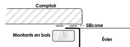
**Option 2.** Il est également possible d'utiliser des montants en bois combinés avec du mastic silicone pour maintenir l'évier contre le comptoir sans utiliser de supports de montage.
