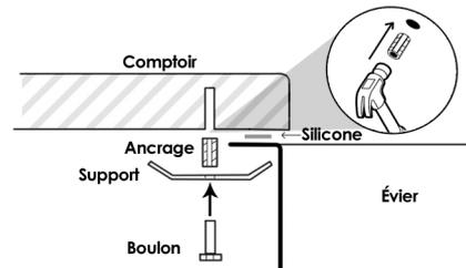
**Option 1.** Insérez des ancrages sous le comptoir sur les trous percés, afin qu'ils soient prêts à fixer la bordure de l'évier. Les ancrages doivent être insérés à l'aide d'un marteau jusqu'à ce que la surface soit lisse.
