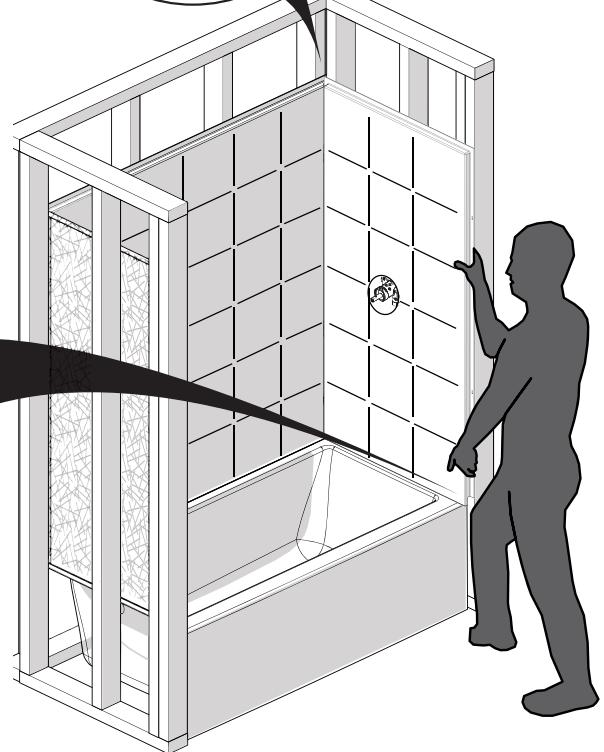
Perforar los pre-agujeros de la brida del muro lateral solamente (15), con una broca de 1/8" alineando con cada montante. **No perforar los montantes.** Fijar el muro temporalmente a un montante usando un tornillo # 8 x 1 3/4" (no incluido).
