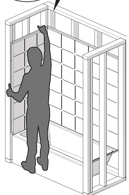
Instalar el muro lateral (15) que tiene los agujeros de la válvula. Poner el muro a aproximadamente 3" por encima del reborde de la bañera, empujarlo a fondo contra el muro posterior y descenderlo sobre el reborde de la bañera.
