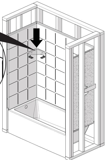
Insertar las tapas de la fijación de repisa (9) en las arandelas (8). Alinear los agujeros de la repisa y los de los soportes (6) e insertar el ensamblaje de la tapa (9). Bajo la repisa, insertar los tornillos #10 x 1/2" (10) y apretar con la llave allen (11).
