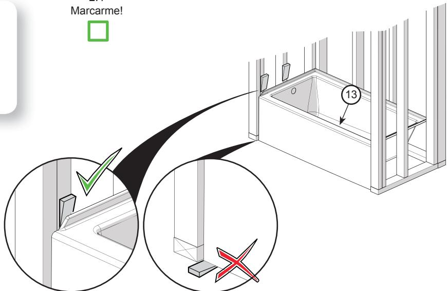
Perforar los pre-agujeros de la brida de la bañera solamente con una broca de 1/8". **No perforar los montantes.** Fijar la bañera a todos los montantes usando tornillos # 8 x 1 3/4" (no incluidos).
