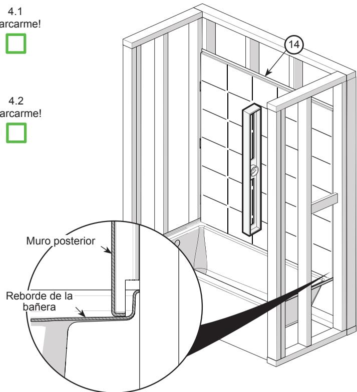
Perforar los pre-agujeros de la brida del muro posterior solamente con una broca de 1/8" alineando con cada montante. **No perforar los montantes.** Fijar el muro temporalmente a un montante usando un tornillo # 8 x 1 ¼" (no incluido).
