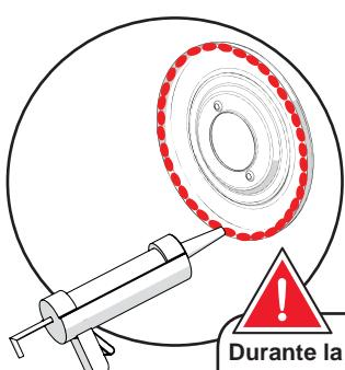
Durante la instalación de la placa frontal de la válvula o de otros componentes, aplicar silicona en el borde exterior.
