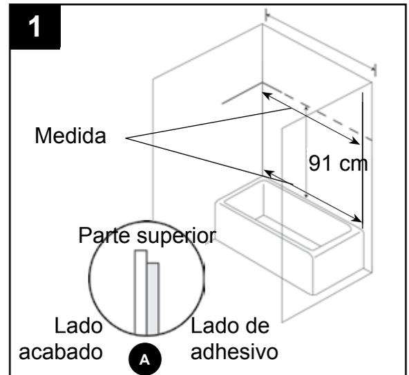
2. Verifique las medidas y coloque cinta adhesiva (no se incluye) sobre el área en donde la sierra (no se incluye) entrará en contacto con el lado acabado del panel posterior inferior (A). Corte el panel posterior inferior (A) y haga los ajustes necesarios a los cortes con un bloque de lijar (no se incluye).
