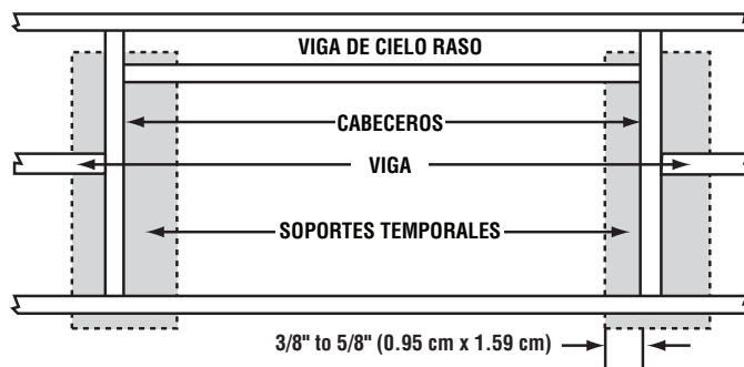
FIGURA 4 - ABERTURA ENMARcada CON LISTONES DE SOPORTE TEMPORAL LISTOS PARA RECIBIR LA ESCALERA
