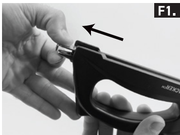
F1. Pull out track release. Saque el desbloqueo de la pista.
