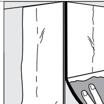
Cuando la cantonera esté en posición, use una espátula de 4 pulgadas para aplicar una capa delgada de compuesto sobre el revestimiento de papel, mientras presiona para escurrir el exceso de compuesto a fin de eliminar las burbujas de aire.
