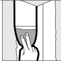
Deje que la primera capa se seque durante la noche. Aplique compuesto para juntas en toda la longitud de uno de los lados con una espátula de 5 pulgadas. Limpie todo el compuesto que se traslape sobre el otro lado. Extienda el compuesto más allá de la primera capa y deje que se seque. Cuando el primer lado esté seco, aplique compuesto en el otro lado y extiéndalo de la misma manera.
