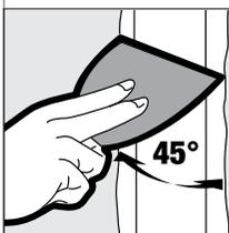
Para obtener mejores resultados, aplique una presión mediana y mantenga la espátula a un ángulo de 45° con respecto al panel. Para una aplicación más fácil, se recomienda diluir el compuesto para juntas con un poco de agua. Por un galón de compuesto, añada agua en incrementos de 2 onzas a la vez.
