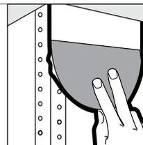
Con una espátula de 8 pulgadas, aplique compuesto para juntas en toda la longitud de una de las bridas. Sujete la espátula a un ángulo de 45° y alise el compuesto. El compuesto debe extenderse sobre el panel a una distancia de 4 pulgadas como mínimo. Repita la aplicación para la otra brida.
