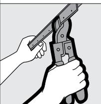
Recorte una longitud 1/2 pulgada más corta que la altura de la pared cortando a través de cada brida con tijeras para metal, después dóblelas y despréndalas. Sostenga firmemente la cantonera contra la esquina y clávela o atornillela a través de los orificios pequeños situados a cada 9 pulgadas en cada brida.
