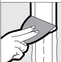
Retire el exceso de compuesto para juntas de los bordes y aplique como una capa delgada sobre la cinta.
