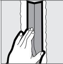
A continuación, doble la cinta en el centro del doblez y presiónela levemente en posición con sus dedos.
