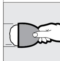
En cada orificio de sujetador, aplique horizontalmente compuesto para juntas con una espátula de 5 pulgadas.
