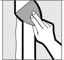
Centre y presione levemente con los dedos para incrustar la cinta para juntas. Pase la espátula de 6 pulgadas firmemente para incrustar la cinta, pero mantenga suficiente cantidad de compuesto para juntas debajo de la cinta para evitar las burbujas.
