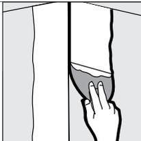
Con una espátula de 4 pulgadas, aplique compuesto a las superficies del panel de pared, extendiendo el compuesto un poco más que el ancho de la moldura.
