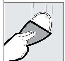
Después, levante la espátula hasta colocarla en posición vertical y limpie el exceso con una pasada en ángulo recto. El compuesto deberá estar al mismo nivel que la superficie del panel.
