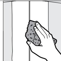
Se puede usar una esponja húmeda para retirar el exceso de compuesto que sobresalga del ancho del borde de la espátula. Deje que se seque.
