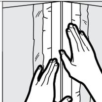
Presione la cantonera metálica revestida de papel en posición e incrustela en el compuesto, pasando una espátula a cada lado, con una presión uniforme, a un ángulo de 45°.
