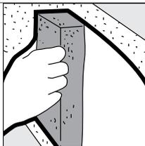
Cuando se requiera sólo un mínimo de lijado, intente lijar en húmedo con una esponja. El lijado en húmedo elimina el polvo y no raspa el papel superficial. Utilice una esponja de poliuretano de celdas pequeñas, que tiene un aspecto similar al fieltro. Sature la esponja y exprímala para que no gotee. Frote las juntas para eliminar los puntos altos, haciendo tan pocas pasadas como sea posible. Limpie frecuentemente la esponja durante su uso.
