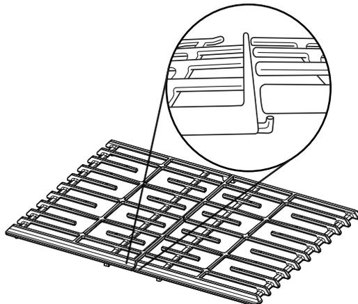
Sur certains modèles, les deux grilles sont identiques et peuvent être utilisées du côté gauche ou droit de la table de cuisson. Les grilles conçues pour être utilisées uniquement sur un côté de la table de cuisson portent les indications "LEFT" (gauche) ou "RIGHT" (droite) sur leur face inférieure.
