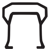
Profil de la rampe supérieure
