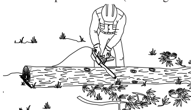
Figure 12 - Tronçonnage d'une bille qui repose entièrement au sol
