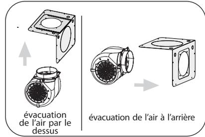
■ Les instructions qui suivent concernent l'installation du moteur intérieur. **AVERTISSEMENT:** à fin de reduire le risque de incendie et de shock électrique il faut installer la hotte seulement avec le moteur a l'intérieur modèles CBI-290C, CBI-390A ou CBI-600A.
