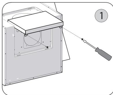
2. Dévissez les (6) vis fixant la plaque du moteur au corps moteur et enlevez la plaque. Fig.2
