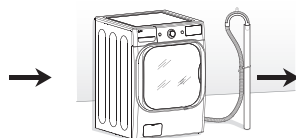
Conexión del tubo de desagüe
