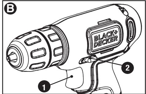
**REMARQUE :** la position du centre du bouton de commande verrouille l'outil en position d'arrêt. Toujours relâcher la détente avant de changer la position du bouton de commande.
