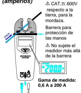
La mordaza acepta cables hasta calibre 1/0 (cobre)(diámetro máximo: 12,7 mm / 0,5")
