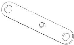
F03 LINKAGE STRAP - A4M02229 (x1) 1/8"x11/16"x3 13/16" (3x17x97)
