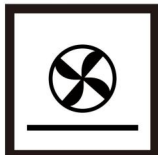
Okrągły wentylator nagrzewnicy z dolnym elementem
