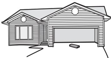
2 Appuyez sur le bouton poussoir de la télécommande pour fermer la porte. La porte DOIT s'inverser lorsqu'elle entre en contact avec la planche.
