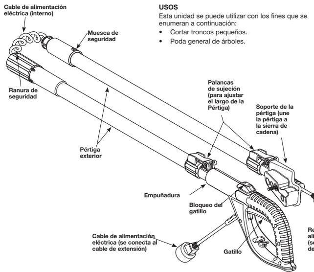
Fig. 2 Ensamblaje de la pértiga telescópica RM1015SPS Remington
