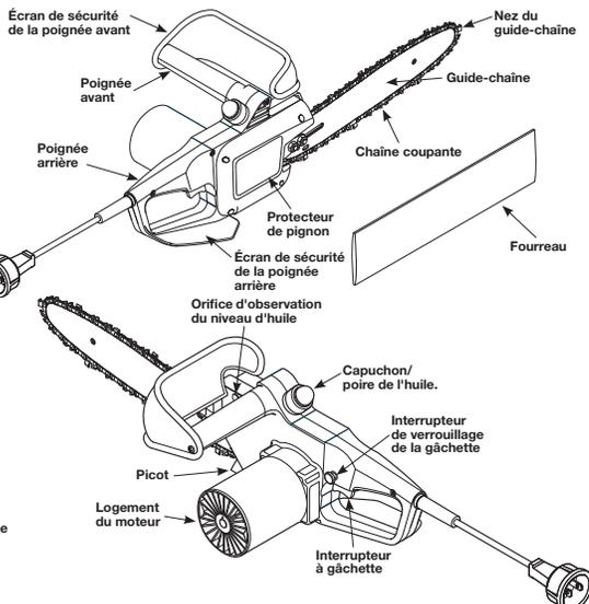
Fig. 3 Tronçonneuse Remington RM1015SPS (côtés droit et gauche)
