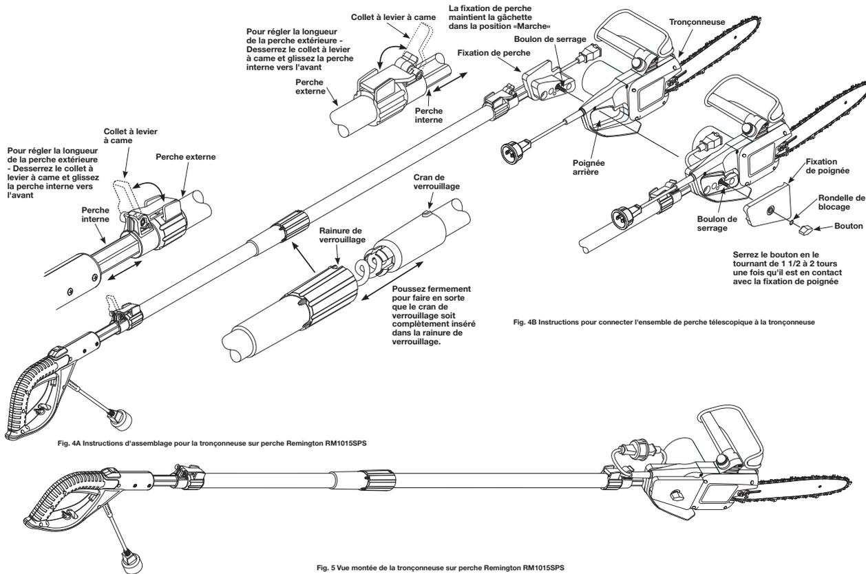
Fig. 4A Instructions d'assemblage pour la tronçonneuse sur perche Remington RM1015SPS
