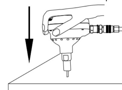
6. Continuez à appuyer jusqu'à ce que le clou soit complètement enfoncé ou jusqu'à ce qu'il pénètre à la profondeur désirée.
