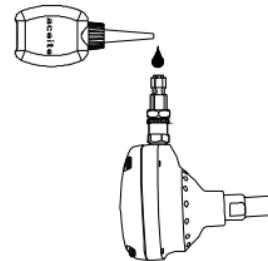
3. Despues de agregar el aceite, haga funcionar la herramienta por un breve periodo. Limpie el exceso de aceite de la salida de la cubierta.
