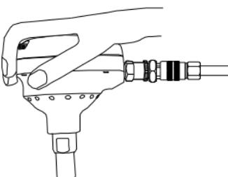
4. Alinee el sujetador y la herramienta en el lugar en donde colocará el sujetador.
