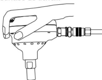
4. Alignez le clou et l'outil à l'endroit où le clou doit être posé.
