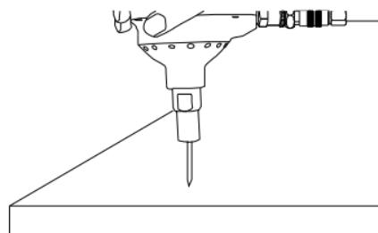
5. Presione suavemente sobre la cabeza del clavo para colocar el sujetador.
