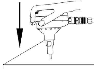
6. Siga aplicando presión hasta colocar por completo el sujetador o hasta alcanzar la profundidad de penetración deseada.
