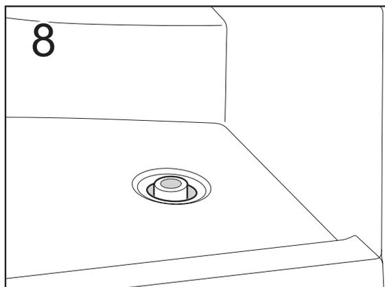
S'assurer que le tuyau d'évacuation dépasse bien dans le raccord de vidange.
