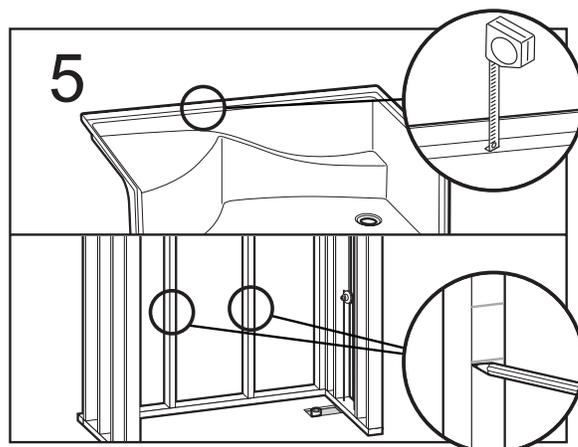
Mesurer la distance entre le haut de la bride horizontale arrière et le bas du rebord de la base, approximativement 1 1/2 po, marquer cette dimension sur les montants arrière, sous la première marque de l'étape 3.
