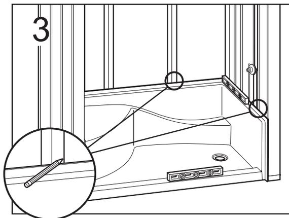
Niveler et marquer tous les côtés. Le tablier avant doit reposer fermement sur le sol.
