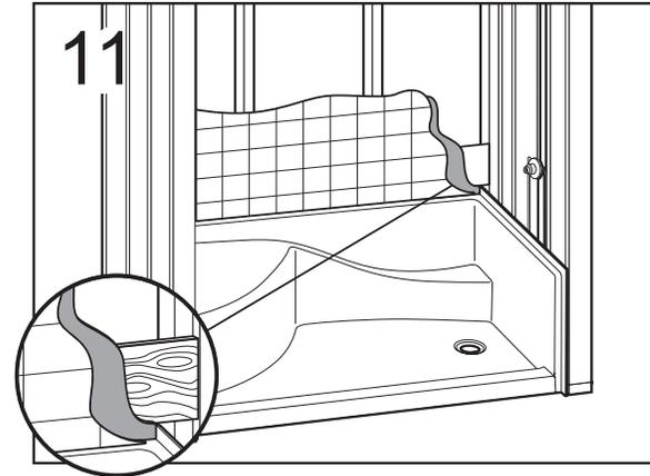
Les panneaux de finition (gypse, carreaux de céramique, etc) devraient couvrir complètement la bride de fixation. Le joint entre les panneaux de paroi et les panneaux de finition peut être recouvert d'une pâte de joint, une bande en matière plastique, ou une bande de carreaux.
