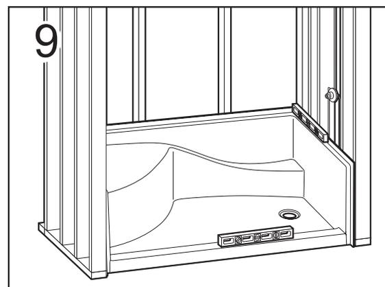
Appuyer vers le bas jusqu'au niveau. Mettre à niveau horizontalement et verticalement en utilisant un niveau. Utiliser des cales si nécessaire. Le tablier doit être appuyé fermement sur le sol.
