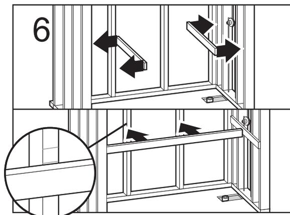
Fixer un 1 "x 3" de bois sur le mur arrière et les côtés de la structure (directement sous les marques).
