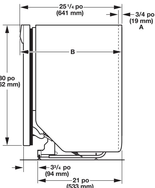
A. L'isolant peut être comprimé (utilisé sur certains modèles).
