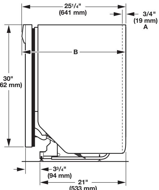
A. El aislante puede estar comprimido (no se utiliza en todos los modelos).
