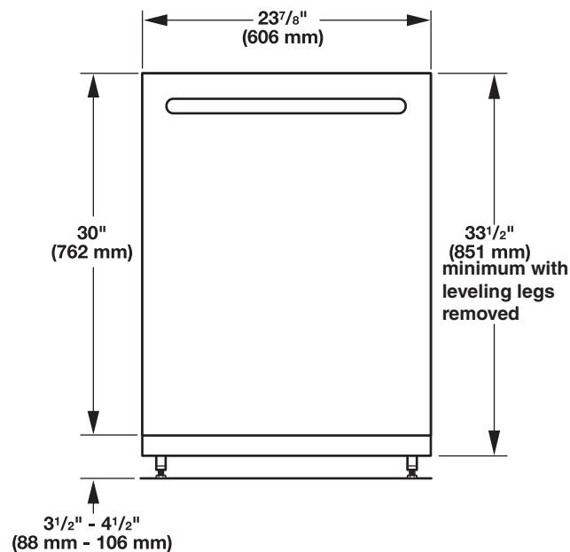
Para un zócalo de 100 mm (4"), la altura de la abertura del gabinete es de 863 mm (34 1/2").
