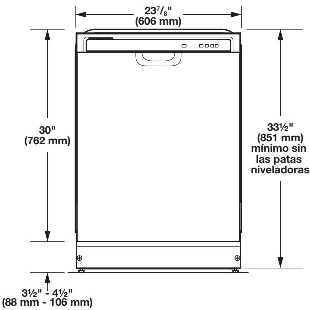
Para un zócalo de 100 mm (4"), la altura de la abertura del gabinete es de 863 mm (34 1/2").
