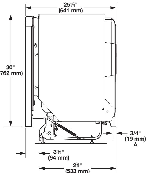
A. El aislante puede estar comprimido (no se utiliza en todos los modelos).
