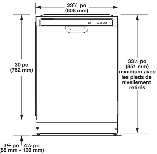
Pour un coup-de-pied de 4 po (100 mm), la hauteur de l'ouverture est de 34 1/2 po (863 mm).
