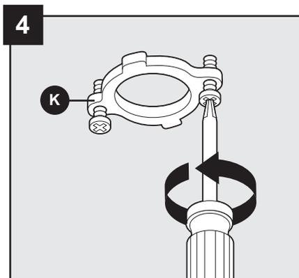
5. Glissez la rondelle de caoutchouc (I) et la rondelle métallique (J) sur la tige du corps du robinet (D). Fixez le corps du robinet (D) au lavabo à l'aide de l'écrou de blocage (K) et des vis préassemblées.
