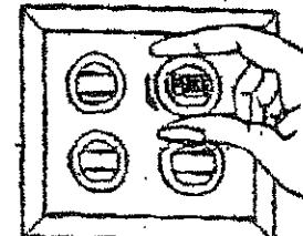
Mettre le luminaire hors tension (intérieure l'interrupteur mural en position "OFF", si le luminaire est munie d'un interrupteur qui a tirage, commuter ou tirer la chaîne pour éteindre le luminaire).
