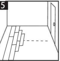
Continuez d'installer les rangées de lattes de cette manière jusqu'à ce que la dernière rangée soit atteinte. Les joints devraient être serrés et sans écarts. Décalez les joints d'extrémité d'au moins 15,24 cm, rangée par rangée et essayez d'éviter les joints en « zigzag ». Le positionnement aléatoire des joints d'extrémité donne une apparence plus authentique à la pose.
