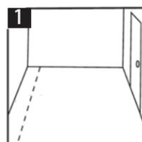
Planifiez votre configuration pour éviter une pose déséquilibrée avec des lattes plus courtes que 22,86 cm ou plus étroites que la moitié de la largeur de la latte le long des murs. Disposez une section du revêtement en largeur et en longueur, et ajustez votre aménagement en conséquence.
