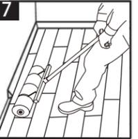
Après l'installation, pressez le plancher terminé en longueur et en largeur à l'aide d'un rouleau d'acier de 45,36 kg à 3 sections. La colle sur les lattes est un adhésif à pression et cette étape assure une adhérence complète au substrat. L'omission de presser le plancher peut occasionner le desserrage ou l'ondulation des pièces du revêtement de sol.
