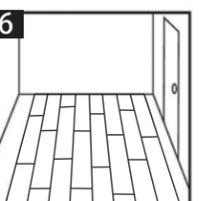
RANGÉES LE LONG DES MURS : Si vous devez diminuer la largeur des lattes sur la longueur des murs, utilisez une règle légèrement plus longue que la latte. Marquez les deux extrémités de la latte à la largeur appropriée et rayez la latte à l'aide du couteau à lame rétractable en utilisant la règle comme guide. Cassez la latte en 2 le long de la rainure et installez la latte coupée contre le mur. Assurez-vous de maintenir le joint d'expansion de 3,18 mm le long de tous les murs.
