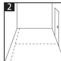
Lorsque la première rangée est déterminée, tracez une ligne parallèle au mur le plus éloigné de la porte. Si la première rangée de lattes doit être coupée, ajoutez cette mesure à la largeur d'une latte complète et utilisez cela comme ligne de départ. Assurez-vous de tenir compte des irrégularités du mur et prévoyez un joint d'expansion de 3,18 mm entre les lattes et le mur. Il s'agit de votre ligne de départ.
