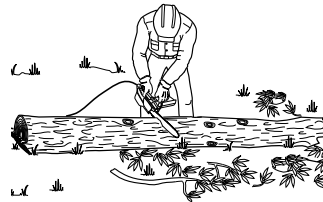
Figura 14 - Trozado del tronco completamente apoyado en el suelo
