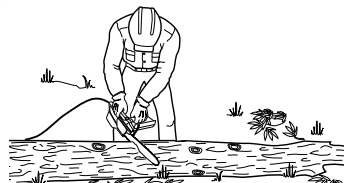
Figure 14 - Tronçonnage d'une bille qui repose entièrement au sol
