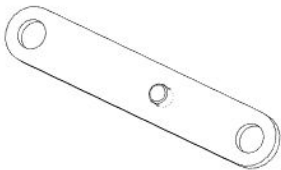
F03 LINKAGE STRAP - A4M02229 (x1) 1/8"x11/16"x3 13/16" (3x17x97)
