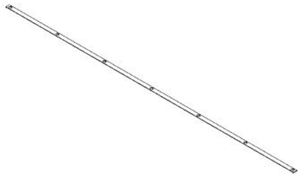
F01 FLAT BAR - A4M02129 (x4) 1/16"x1"x79 5/16" (2x25x2015)
