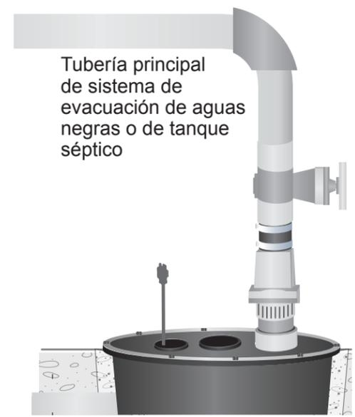
**4** Acople un adaptador macho de 5.1 cm (2 pulg.) en la abertura de ventilación en la parte superior de la tapa. Utilizando un tubo de 5.1 cm (2 pulg.) de PVC y un sistema adhesivo en 2 pasos para PVC, conecte la abertura de ventilación al sistema de ventilación de evacuación de aguas negras. Use cinta de teflón para sellar esta conexión. Se recomienda una unión para facilitar el servicio de la bomba.
