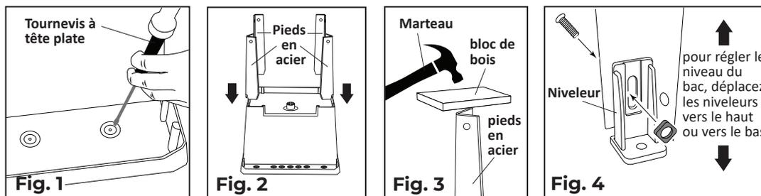
1. Placez le bac à linge sur une surface propre, telle qu'une couverture ou un carton, et retournez-le pour permettre le retrait des perforations préformées afin d'accueillir le robinet qui sera installé. Les bouchons de trou peuvent être déposés à l'aide d'un tournevis à tête plate ou d'un petit burin et d'un marteau (voir la fig. 1).
