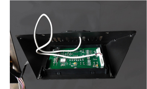
Étape 2 Déballez les meilleurs contrôles de montage et de veiller à ce que le faisceau de câblage illustré est fixé.
