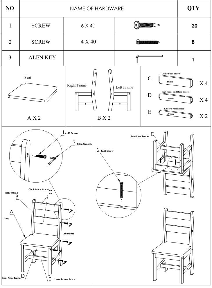
DO NOT TIGHTEN SCREWS BEFORE ADJUSTING STABILITY
