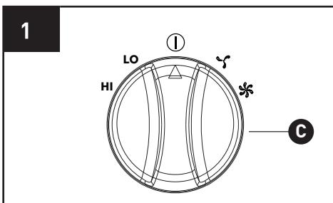
2. Seleccione una configuración de calor o ventilador girando el selector de modo en el panel de control (C) a la posición LO, HI, Velocidad de ventilador 1 o velocidad del Velocidad de ventilador 2.
