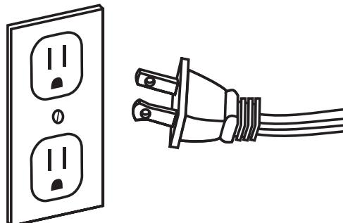
**⚠ ADVERTENCIA:** es normal que el cable de alimentación se sienta caliente al tacto. Sin embargo, si el enchufe está flojo en el tomacorriente, es posible que el enchufe se sobrecaliente. Si esto ocurre, intente insertar el enchufe en un tomacorriente diferente. Póngase en contacto con un electricista calificado para que revise si el tomacorriente original presenta daños.
