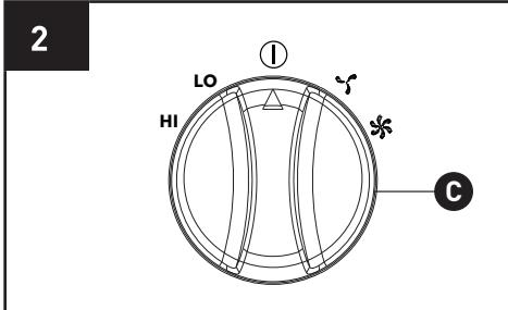
La potencia para configurar el modo "LO" es de 750 W; la configuración del modo "HI" es de 1500 W.
