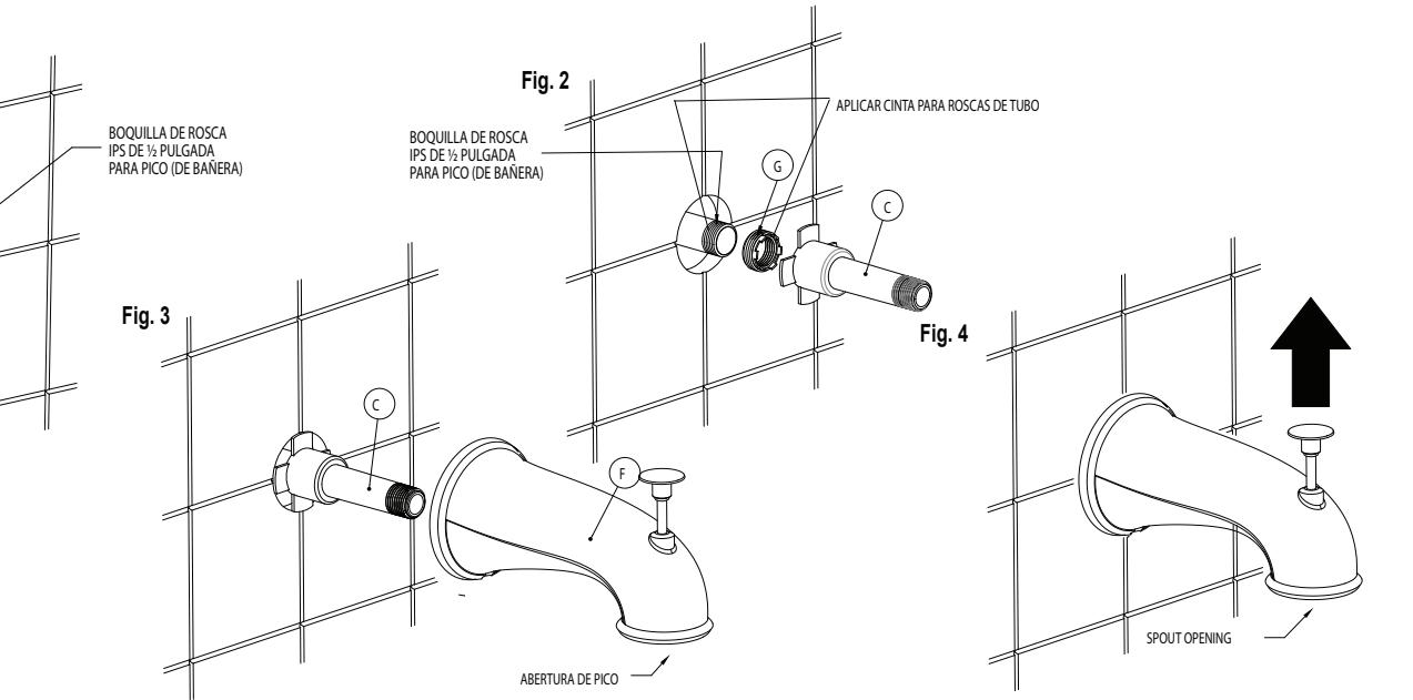
**Figura C. Para la conexión roscada macho de 1/2 pulgada con boquilla larga de pico**
