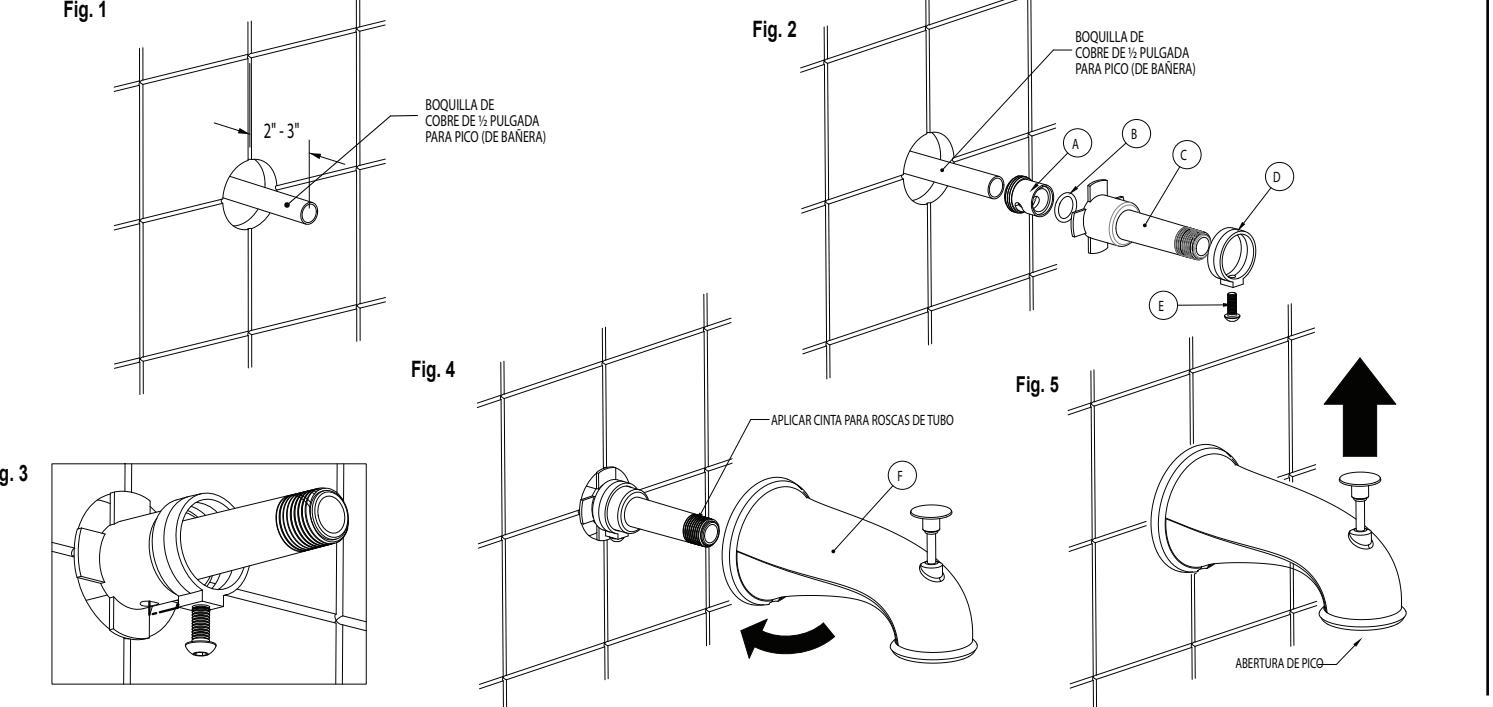
**Figura B. Para la conexión roscada macho de 1/2 pulgada con conexión de pico corto**
