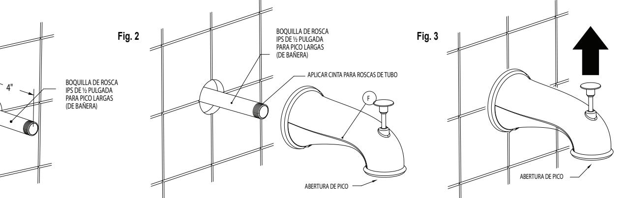
**Figura D. Para la conexión roscada macho de 3/4 pulgada con boquilla corta de pico**
