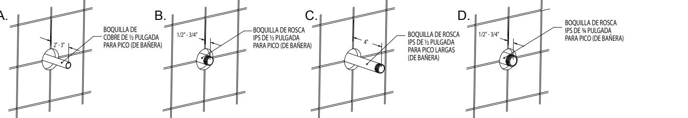
**Figura A. Para las conexiones de tubería de cobre de 1/2 pulgada**
