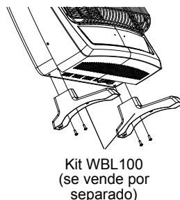
Fig. 13: colocación de las patas
