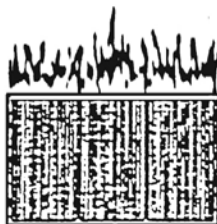
Fig. 29: comportamiento incorrecto o anormal con llamas altas con la perilla de control en llama alta (5)
