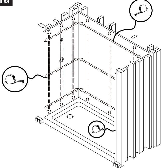
1b. Mida las ubicaciones de los recortes para los accesorios de plomería y márquelos en la parte posterior de los paneles correspondientes.
