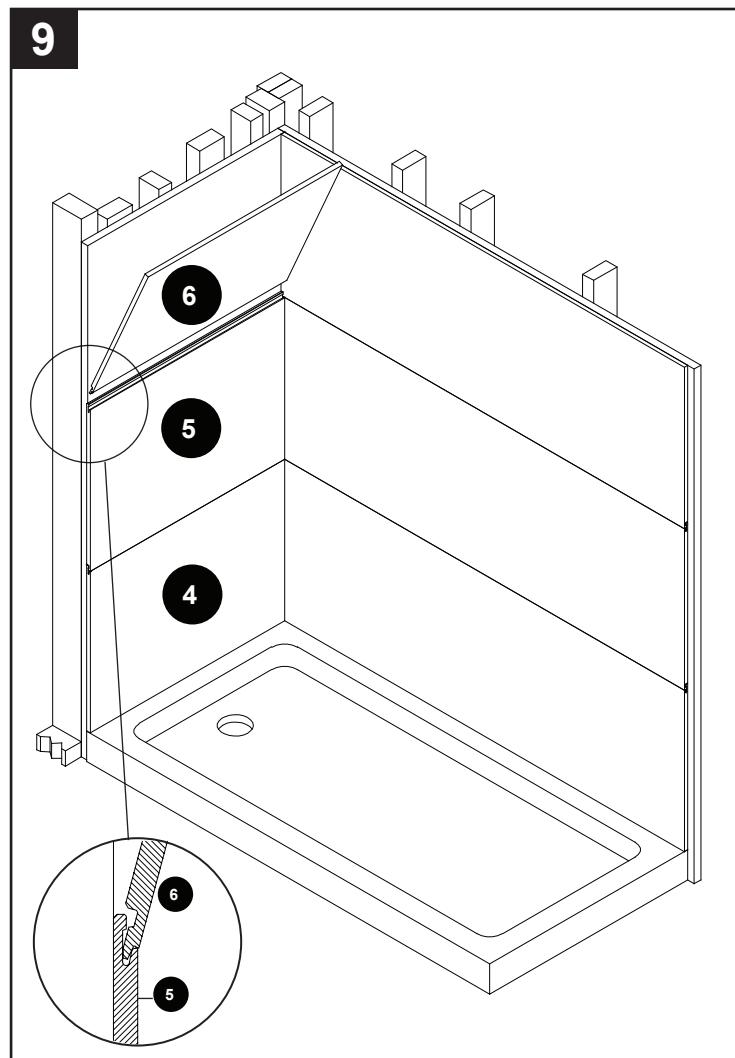
**Nota:** debe tener mucho cuidado cuando instale este panel. El sellado hermético depende de que la lengüeta se inserte firmemente en la ranura antes de que el panel se vuelva a colocar en su posición, ya que la alineación horizontal no se puede ajustar una vez que el panel encaja en su lugar.
