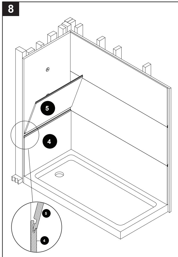
**Remarque :** Appliquez-vous lorsque vous installez ce panneau. Pour assurer l'étanchéité du joint la languette doit être fermement insérée dans la rainure avant de pousser le panneau en position et l'alignement horizontal ne pourra plus être ajusté une fois que le panneau s'enclenche.
