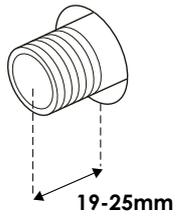
Insérez et serrez le mamelon du tuyau dans le mur rugueux, utilisez la longueur du mamelon selon l'épaisseur de votre mur et la profondeur approximative, un mamelon inclus, mais le plombier peut avoir besoin d'utiliser une taille différente. Il est recommandé que le filetage de l'embout dépasse de 19 à 25 mm.
