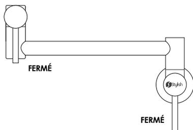
Avec les deux poignées de remplissage de la cuisinière en position fermée et ouvrez l'alimentation d'eau.
