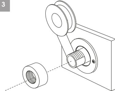
Vissez la bague réglable à la plaque décorative et enveloppez la zone exposée du tube avec du Teflon.
