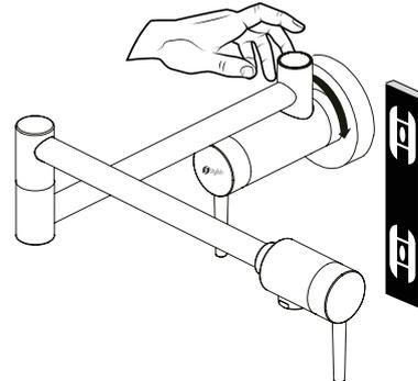
Ce remplisseur de pot a un anneau réglable sur la base qui est utilisé pour serrer le réservoir de remplissage, ajustez l'anneau jusqu'à ce que le réservoir de remplissage soit fermement en place.
