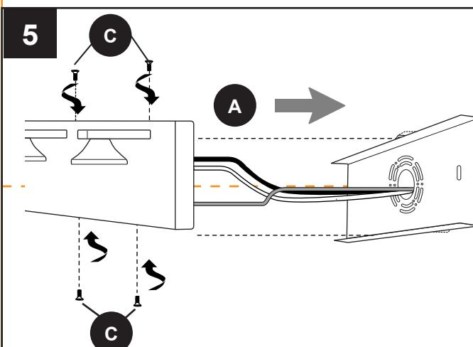
Before tightening C completely, use level (not included) to check A -- adjust if necessary. Avant de serrer complètement les C, vérifiez A à l'aide d'un niveau (non inclus); au besoin, ajustez A. Antes de apretar completamente C, examine A con un nivel (no incluido) -- ajústela si es necesario.
