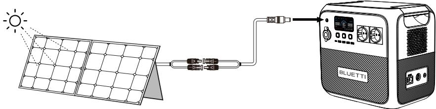
**Achtung!** Die Leerlaufspannung von Solarpaneelen darf 60 V nicht überschreiten, da das Gerät andernfalls Schaden nimmt.
