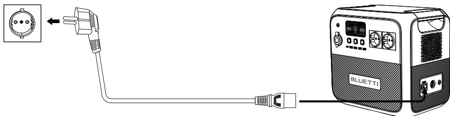
Die AC180 unterstützt die Lademodi „Turbo“ (Schnellladen), „Standard“ und „Silent“ (leise). Die Voreinstellung lautet „Turbo“. Die Modi „Standard“ und „Silent“ können in der BLUETTI App aktiviert werden. BLUETTI empfiehlt folgende Modi für das Laden von Wechselstrom:
