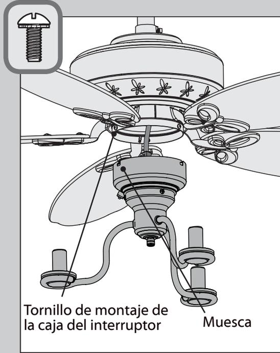
Tornillo de montaje de la caja del interruptor      Muesca
