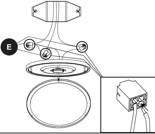
Connect:L-L,N-N,GND-GND./Raccordez: LL, NN, GND-GND./
