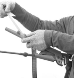
Envolver ajustadamente la cinta para herramientas (DXDP810100) alrededor del nudo de anclaje para lograr un agarre firme y una fijación fuerte y estable del nudo en la herramienta.
