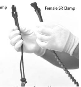
Combinez les pinces mâles et femelles pour joindre les deux. Cette combinaison des pinces mâles et femelles forme un mécanisme de verrouillage suffisamment solide pour tenir votre outil en travaillant en hauteur.
