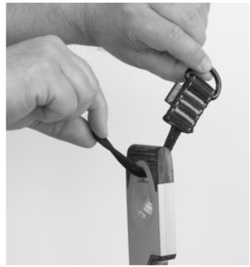
Passer tout d'abord la boucle dans le trou de l'outil et passer l'extrémité du dé d'accrochage dans la boucle d'accessoire d'outil en faisant un nœud sur le trou de l'outil.
