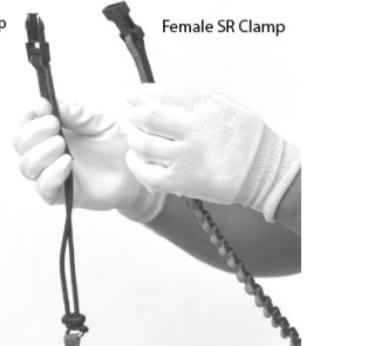
Combinar las hebillas macho y hembra para unirlas como una sola. Esta combinación de hebillas macho y hembra forma un mecanismo de bloqueo que es lo suficientemente fuerte como para sostener su herramienta mientras trabaja en altura.
