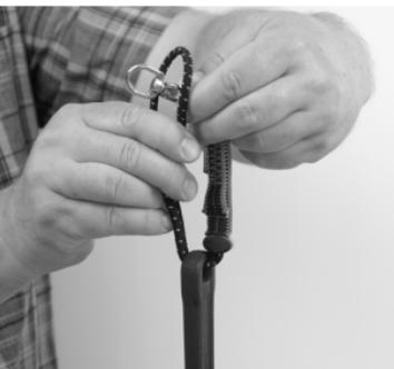
Bloquear firmemente el nudo con un seguro de cordón, y la conexión elástica de la herramienta estará lista para usar.
