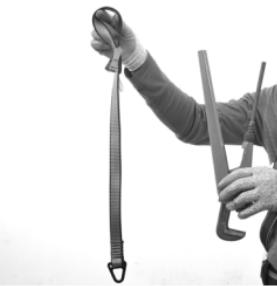
Desenredar el anclaje para herramientas y pasar el lazo del otro extremo a través de la herramienta deseada.
