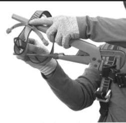
Détacher l'ancrage de l'outil et passer la boucle à l'autre extrémité à travers l'outil désiré. Ensuite, serrer la boucle sur l'outil et enrouler fermement les deux ailettes de l'ancrage de l'outil sur l'outil pour une prise solide sur l'outil. Étirer la sangle de l'ancrage de l'outil pour faire un nœud serré sur l'outil.
