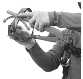
Ahora enganchar el lazo sobre la herramienta y envolver firmemente las dos alas del anclaje para herramientas sobre la herramienta a fin de lograr un agarre firme de la herramienta.
