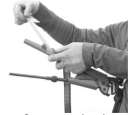
Envelopper fermement le ruban à outils (DXDP810100) autour du nœud d'ancrage pour une prise ferme et une fixation stable du nœud sur l'outil.
