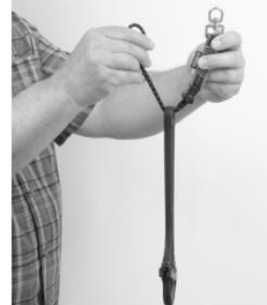
Faire d'abord passer la boucle dans le trou de l'outil et faire passer l'extrémité du dé d'accrochage dans la boucle de l'accessoire d'outil en faisant un noeud sur l'œillet de la sangle.
