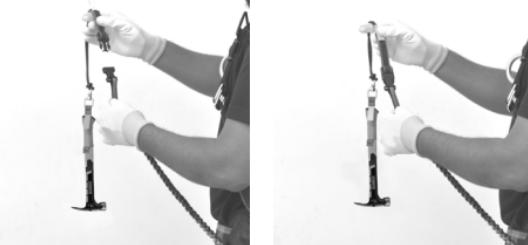
Unir las hebillas macho y hembra para conformar una unidad, y la conexión elástica de retroadaptación para herramientas estará lista para usar.
