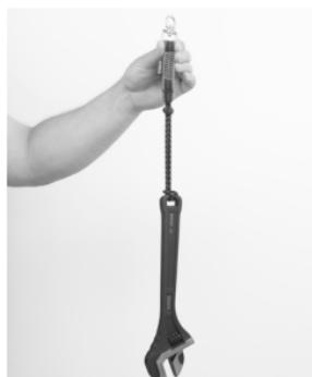
*Pasar primero el lazo a través del orificio de la herramienta y pasar el extremo del anillo en D a través del lazo de sujeción de la herramienta formando un nudo sobre el ojal para amarre.*
