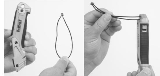
El conector de alambre para herramientas se puede conectar a herramientas con ojal para amarre (por ejemplo, cuchillo de uso).
