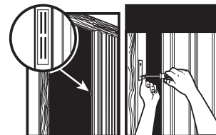
Imán de la puerta Instale la placa de encastre
