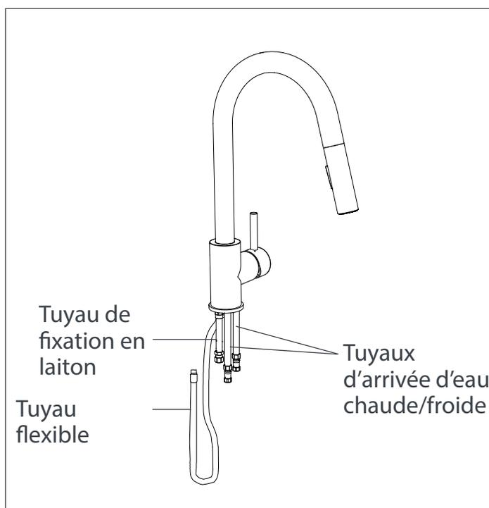
**3** Ajoutez le col et le joint torique au robinet et raccordez les tuyaux tressés de l'eau chaude/froide aux tuyaux d'arrivée.
