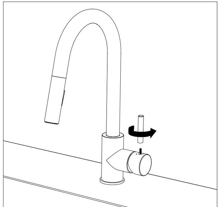
**2** Desserrez la vis encastrée dans la poignée en utilisant une clé hexagonale (incluse) et retirez la poignée.
