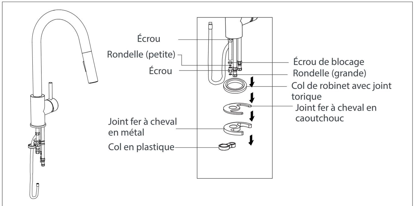
**2** Identifiez le tuyau flexible, les tuyaux d'arrivée et la tige de fixation raccordés à la base du robinet.
