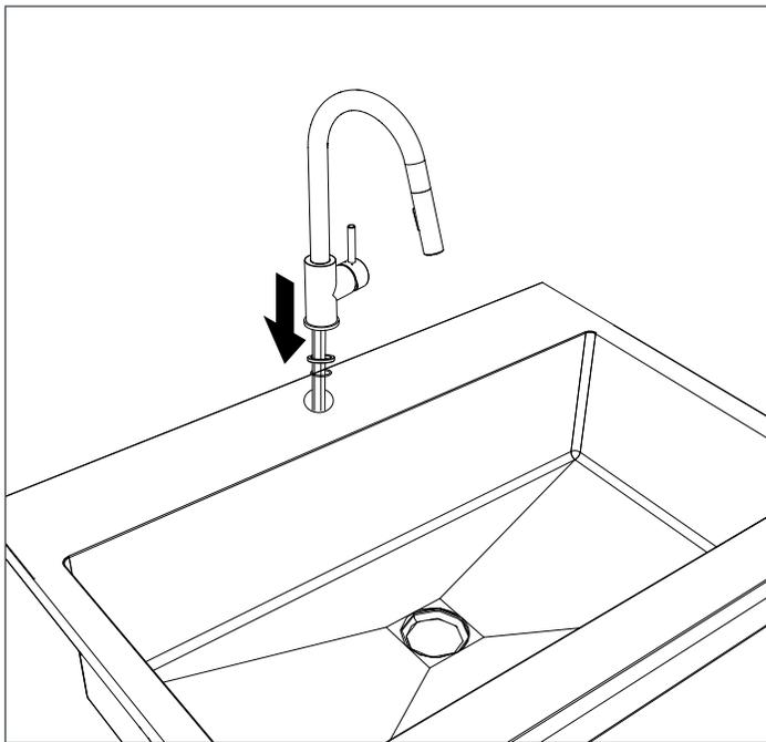
**6** Installez un col en plastique avec le petit trou passant à travers le tuyau de fixation en laiton et le grand trou à travers le tuyau flexible. Faites glisser le poids sur le tuyau flexible. Serrez les vis sur le poids.
