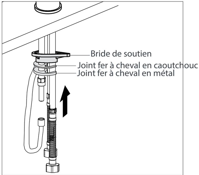
**7** Raccordez le tuyau flexible sur le tuyau de fixation en laiton.
