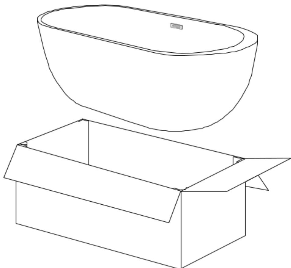
2. Sørg for at overflaten du vil installere badekaret på er flat. Juster høyden på badekarets ben for å sikre stabilitet. Hvis det ikke gjøres riktig, kan det hende at vannet ikke tømmes ordentlig og kan skade badekaret.
