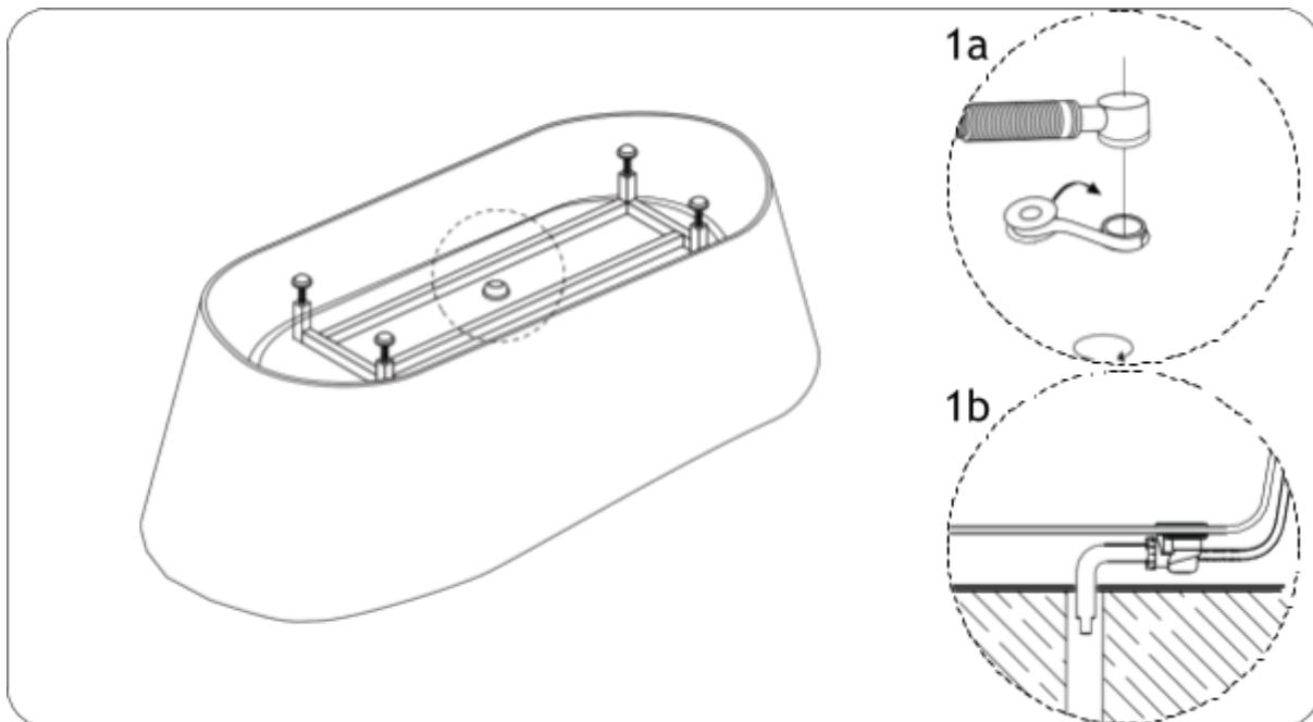
4. Po podłączeniu wannę prosimy o wlewanie do niej wody w celu przetestowania jej. Jeżeli woda poprawnie spływa, produkt został zamontowany prawidłowo i jest gotowy do użytku.
