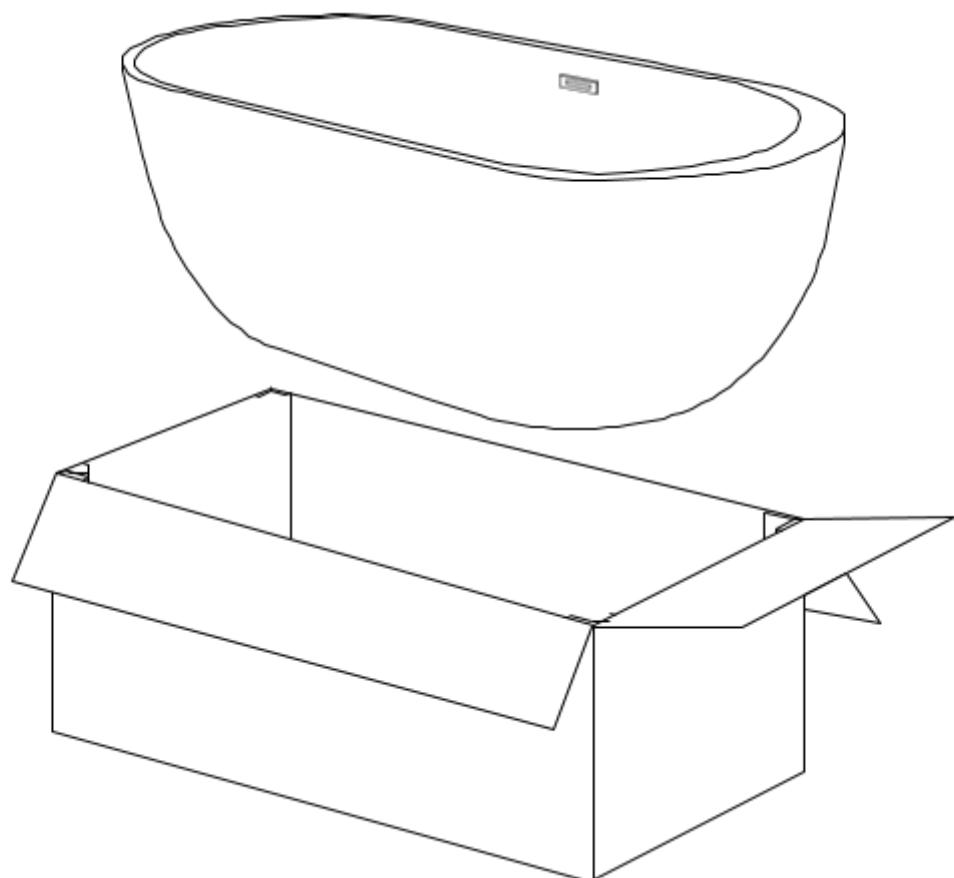
2. Ujistěte se, že povrch na který vanu pokládáte je rovný. Pro zajištění stability nastavte výšku nohou. Pokud toto nebude správně nastaveno, voda může špatně odtékat a způsobit poškození.
