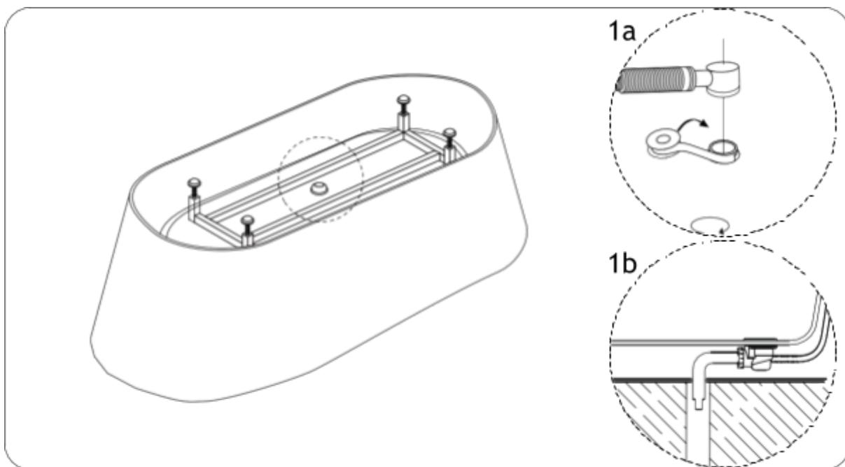
4. Dopo l'installazione, testa la vasca riempendola d'acqua. Se si scarica correttamente e completamente, significa che è stata installata adeguatamente ed è pronta all'uso.
