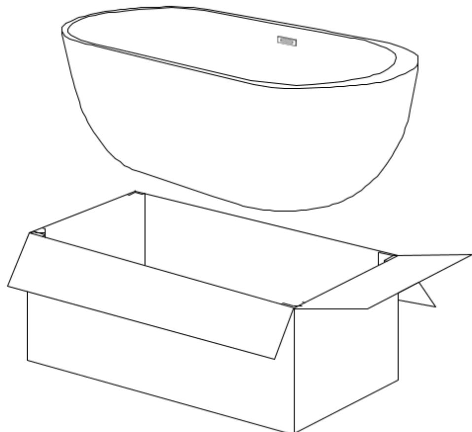
2. Stellen Sie sicher, dass der Boden, auf dem die Badewanne stehen soll, eben ist. Passen Sie die Höhe der Wannenbeine an, um die Standsicherheit der Wanne zu gewährleisten. Andernfalls kann das Wasser nicht richtig abfließen, wodurch das Modell beschädigt werden könnte.
