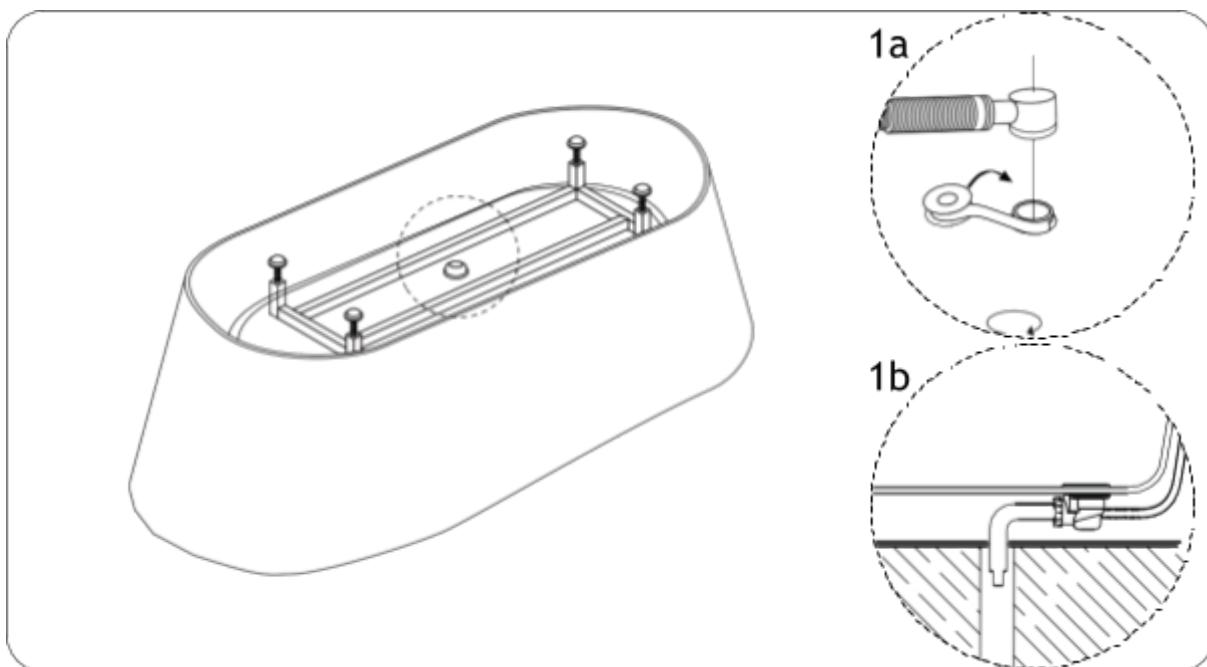
4. Nach dem Einbau sollte die Badewanne testweise mit Wasser befüllt werden. Wenn das Wasser vollständig und problemlos abläuft, dann wurde das Modell korrekt installiert und kann benutzt werden.
