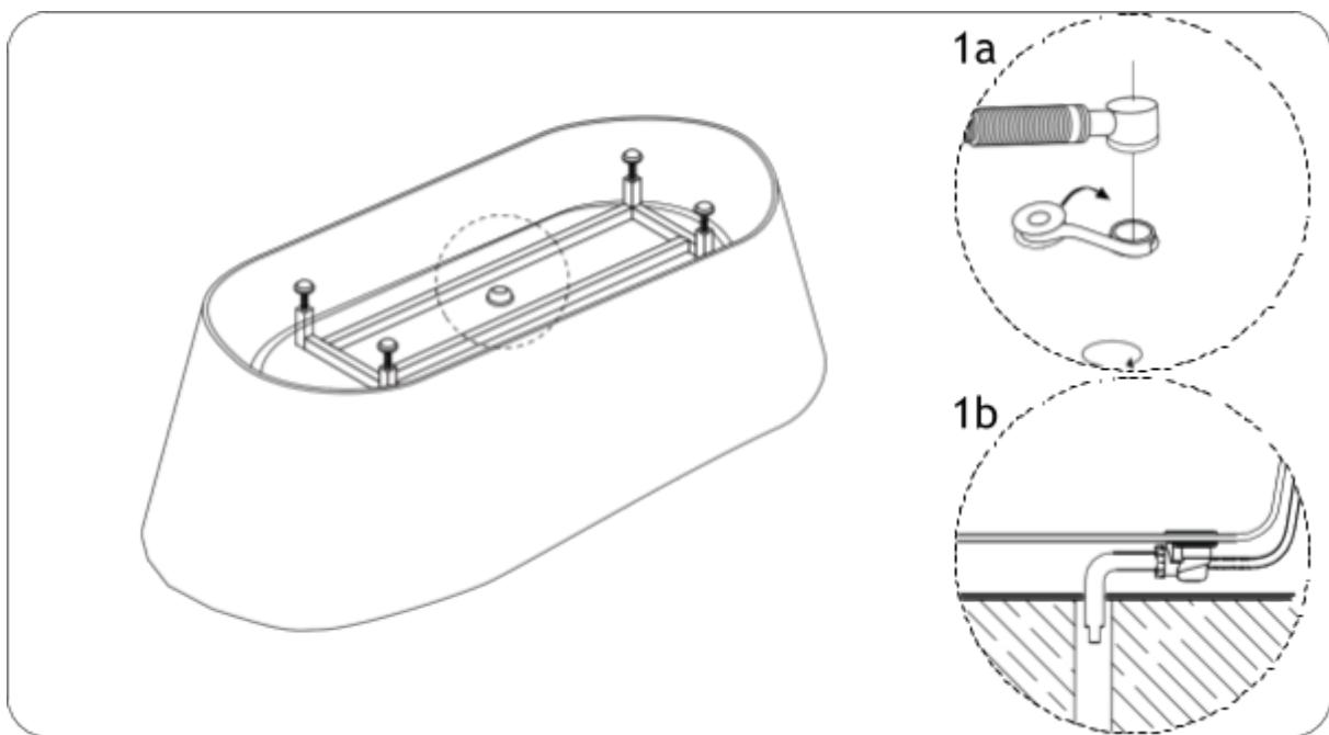
4. Una vez finalizado el proceso, llene la bañera con agua. Compruebe que el drenaje se está realizando de forma correcta, sin fugas. Si es así, la bañera ha sido instalada de forma correcta y está lista para su utilización.
