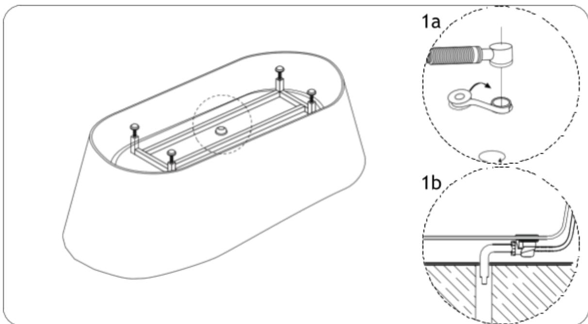
3. Test na de installatie of deze goed is uitgevoerd door de badkuip met water te vullen. Als het water volledig en naar behoren wordt afgevoerd is de badkuip correct geïnstalleerd en is hij klaar voor gebruik.
