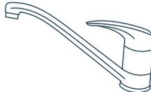
L'extrémité avant doit être plus longue que 0,4 pouce. La face de sortie du robinet doit être plate et lisse, sinon limez-la pour éviter les fuites.
