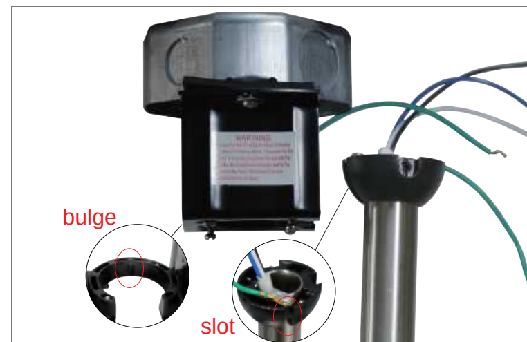
Paso 9 Cuelgue el ventilador en el soporte de suspensión y alinee la ranura de la varilla inferior con la protuberancia del soporte de suspensión.
