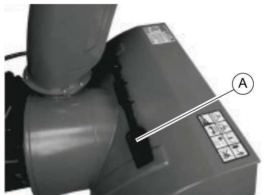
Figura 3-7. Despeje de una obstrucción
