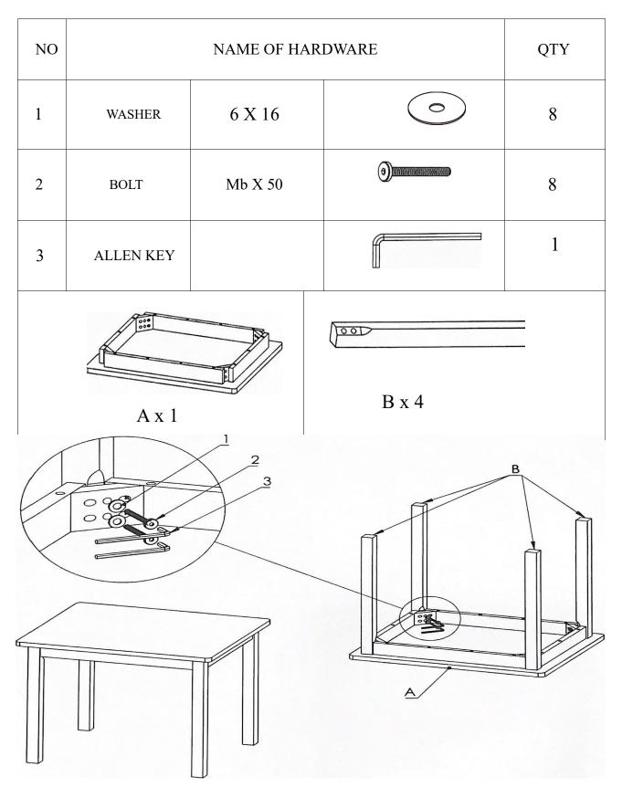
DO NOT TIGHTEN SCREWS BEFORE COMPLETELY ASSEMBLED
