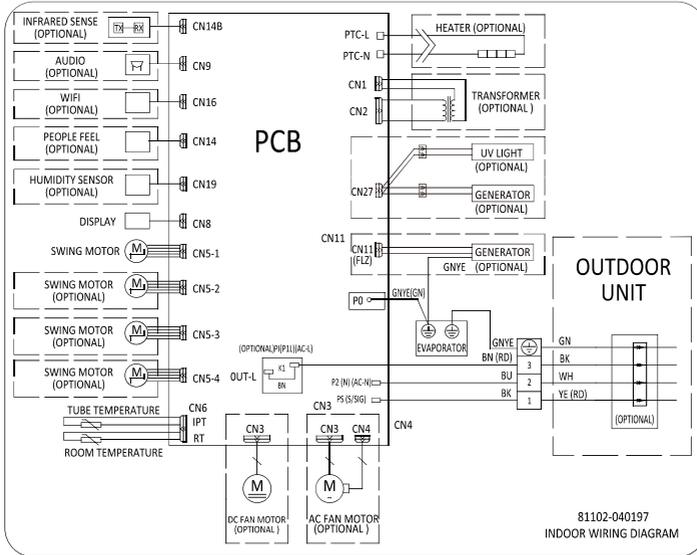
12K/18K (Wiring diagram)
