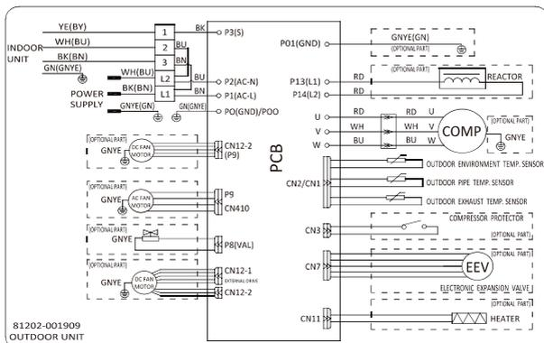
12K/18K/24K/30K/36K(230V) Wiring diagram
